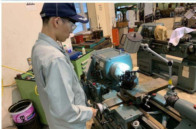
円形の鋼材を切削します
