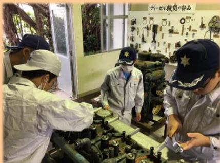
船のエンジンの特性や分解・組立技術、エンジンを修理する技術、運転状態の確認の仕方を学びます。
