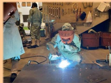
生徒主体で設計図を描き、鉄を切断し、ガス、アーク(電気)溶接を行い製品を作成します。
